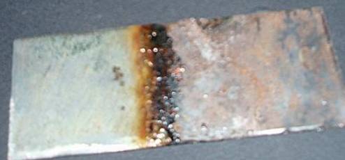
Пластина 2. В жидкости с ингибитором коррозии
